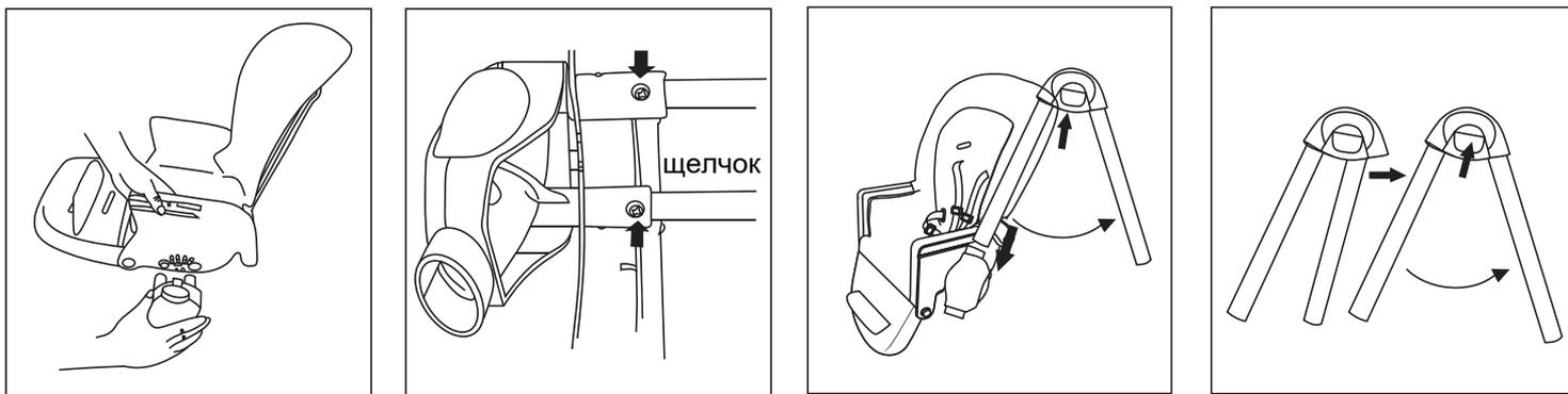
Установите передние ножки на опору с колесиками. Для этого вставьте ножки в отверстия опоры и нажимайте на них до тех пор, пока они не зафиксируются при помощи расположенных внутри подпружиненных штырьков. Повторите то же самое задней опорой.
