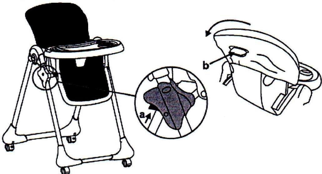
9. Выбор положения подножки. Всего 2 положения подножки. Нажмите на кнопки **A** с двух сторон подножки одновременно и поднимите или опустите подножку в желаемое положение. Отпустите кнопку и затем слегка сдвиньте подножку так, чтобы она закрепилась.
