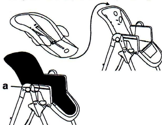
6. Установка и использование двойного подноса/столика. Потяните рычаг **a** с обратной стороны столика и установите столик в специальные пазы **c** по бокам в подлокотниках. Отпустите рычаг и слегка подвигайте столик, чтобы столик закрепился.
